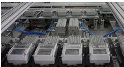
图 3 待检测的电能表
