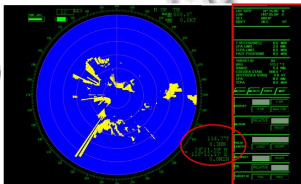
图 5 雷达/ARPA 模拟器运行界面
