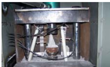
图8 岩样受载实验过程
