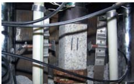
图9 正在做岩样11号的受压实验
