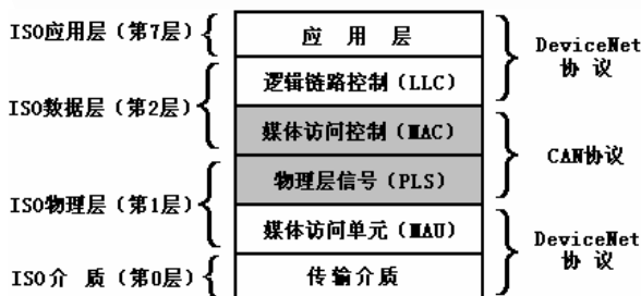
图 2 DeviceNet 的 ISO 层次
