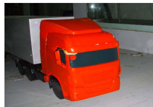
图 9 某卡车风洞试验模型现场图
