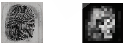
(a) 原图 (b) Gabor 滤波输出特征图像 图 1 原图及 Gabor 滤波输出特征图像
