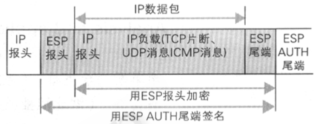
图 5 隧道模式下 ESP 报文格式
