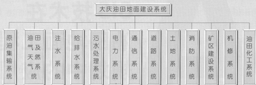
图1 大庆油田地面建设系统框架图
