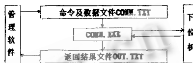
图5 PC机与读写机通信过程
