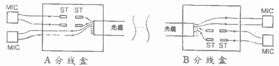
图 5 MIC 端子通过 ST 活动连接器与光纤连接
