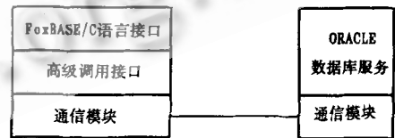
图 8 “客户/服务器模式信息系统支撑环境”结构简图
